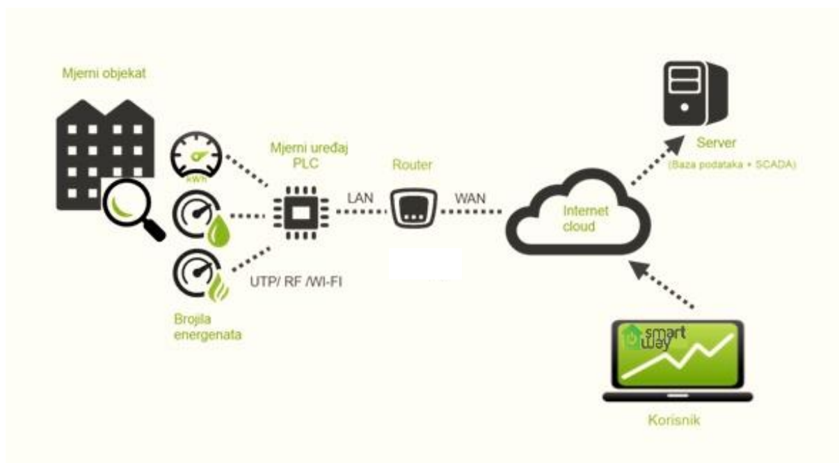
Slika 3: Načelni prikaz rada SmartWay sustava za praćenje potrošnje energije [5]
